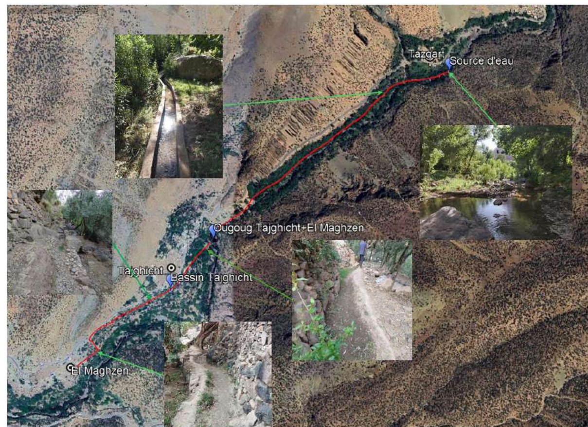
Image: Tracé de la rigole d'irrigation desservant les trois douars d'Aguendiss
